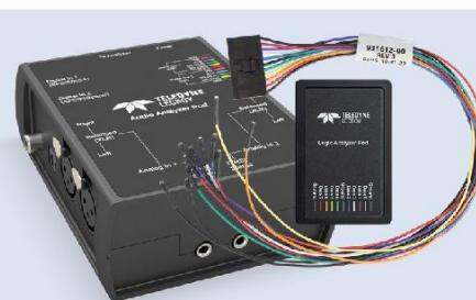
音频分析模块与逻辑分析模块可以精确测量整个系统的延迟，包括传输延迟、播放延迟以及音频处理延迟——这些都是下一代 LE Audio 设备开发过程中至关重要的指标。这些功能同样适用于蓝牙经典设备，在各类蓝牙音频技术中具有广泛适用性。
